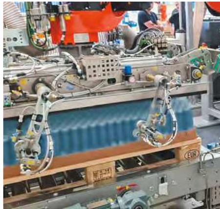
sungen. Bemerkenswert ist die Leistung von bis zu 330 Aerosoldosen mit einem Durchmesser von 53 Millimetern je Minute. Bei kleinerem Durchmesser können weit höhere Leistungen erzielt werden.
