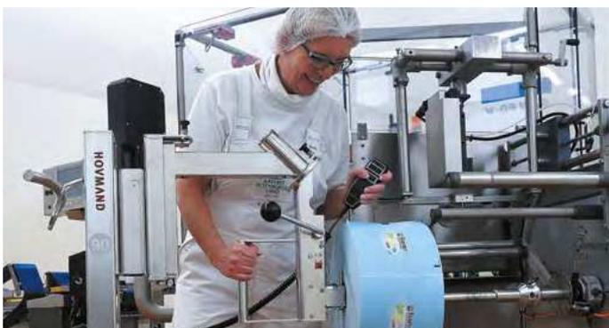
eine Person im Rahmen des Produktionsprozesses Euro-Stapelbehälter, Verpackungsfolien, Eimer und Fässer handhaben und transportieren. Dabei lassen sich bis zu 300 Kilogramm auf einmal bewegen. Das spart Zeit und beschleunigt die Arbeitsprozesse insgesamt, ohne die Angestellten körperlich zu belasten.
