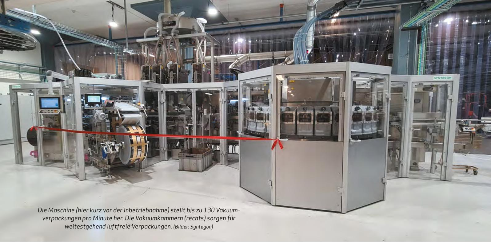
*Die Maschine (hier kurz vor der Inbetriebnahme) stellt bis zu 130 Vakuumverpackungen pro Minute her. Die Vakuumkammern (rechts) sorgen für weitestgehend luftfreie Verpackungen. (Bilder: Syntegon)*
