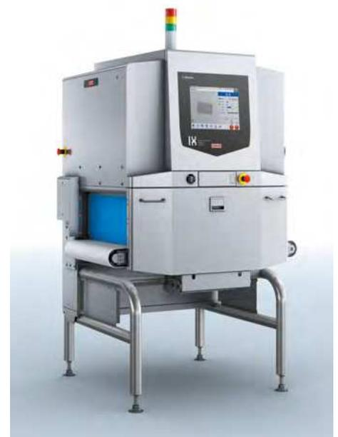
Identifikation leistet das Gerät noch weitere Aufgaben der Qualitätskontrolle wie eine Vollständigkeitsprüfung über Zählfunktion, eine Gewichtsveranschlagung und die Erkennung deformierter oder zerbrochener Produkte. ■
