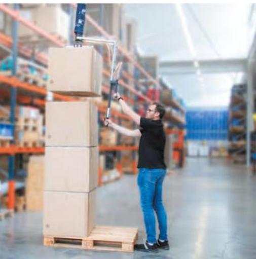
Mit der neuen Lösung stackLift bekommt die etablierte Serie von Timmer Zuwachs. Der Vakuumschlauchheber ermöglicht das Aufnehmen von bodennahen Hebegütern mit einem Gewicht von bis zu 50 Kilogramm in einer aufrechten Körperhaltung und das Stapeln auf eine Höhe von bis zu 2,60 Metern. Besucher können den neuen stackLift sowie zwei weitere Schlauchheber am Messestand in Aktion erleben und selbst ausprobieren.
