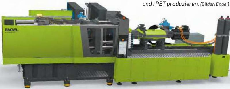
Die Container werden während der K Messe aus rPET direkt im Dünnwand-spritzguss produziert.
