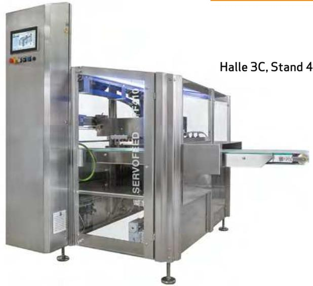
Die Servofeed PF410 dient der herstellerunabhängigen Linieneinzelung nach Tiefziehmaschinen für Produkte von mehrspurigen Produktionslinien auf einen einbahnigen Weitertransport (Bild). Die Anlage übernimmt die Packungsformation am Längsschnitt der Tiefziehmaschine und vereinzelt diese mittels Pick-&-Place-System für nachgeschaltete Linienkomponenten wie zum Beispiel Kontrollwägen, Metalldetektoren und Etikettierer.
