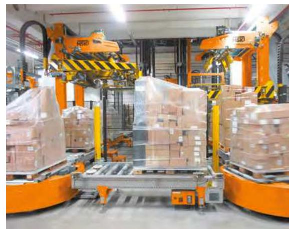
reifungsbänder von Palettenladungen. Dank eines speziellen MSK-Verfahrens zur Trennung der Bänder auf der Palettenladungs- oberseite ist eine Verarbeitung von bis zu 45 Paletten pro Stunde auch bei Mehrfachumreifung und verschiedenen Umreifungsmustern in Mischproduktion möglich. ■
